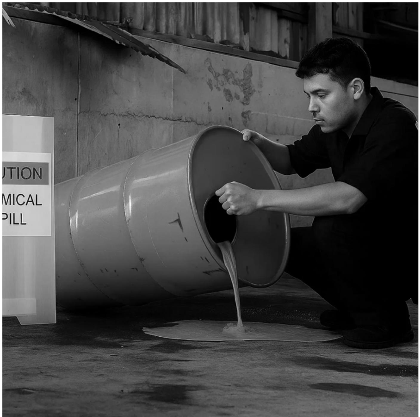
El trabajador está manipulando un barril con fugas de material peligroso sin llevar ningún equipo de protección personal (EPP) visible, como guantes, protección ocular o calzado de protección. Se está permitiendo que el vertido se extienda por el suelo, creando un grave riesgo de resbalón, exposición a productos
