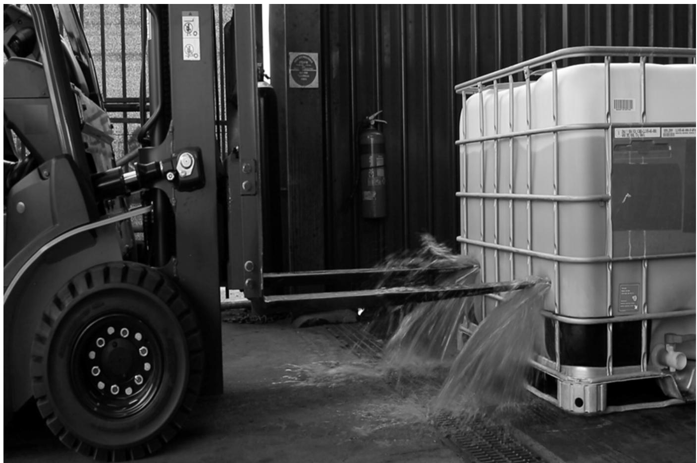
Esta imagen pone de relieve la importancia crítica de realizar comprobaciones previas a la operación en carretillas industriales motorizadas como las carretillas elevadoras. En este caso, las horquillas de la carretilla han perforado un contenedor, provocando un derrame importante de material peligroso. Este incidente podría provocar la contaminación del medio ambiente, lesiones a los trabajadores o incluso un incendio si la sustancia es inflamable.
