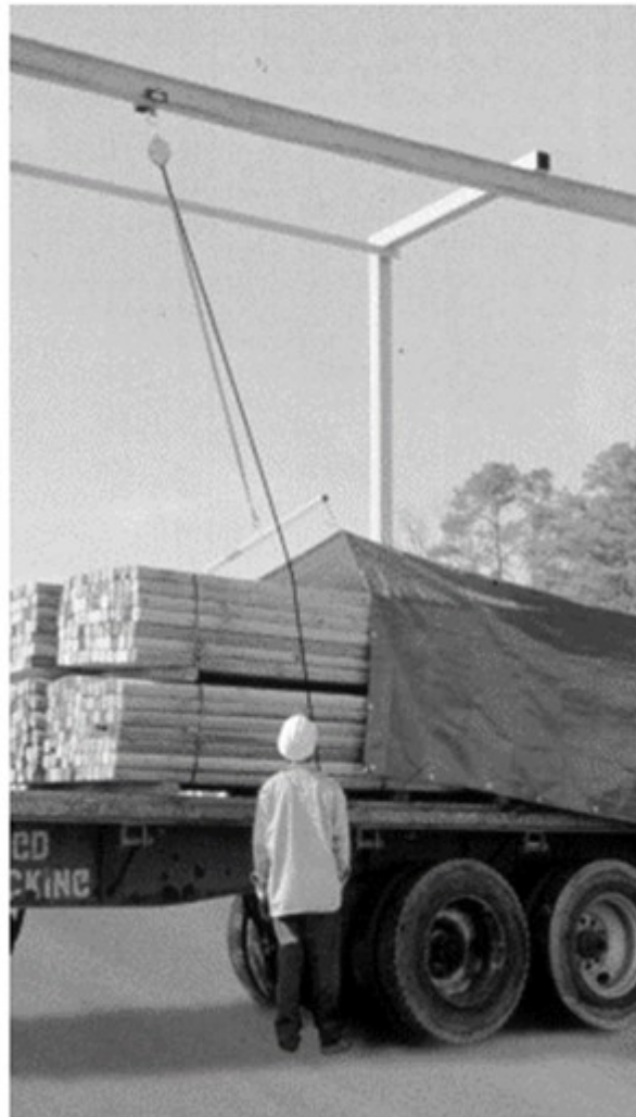
Una manera segura de cubrir las cargas con lona. Foto: ThomasNet News
