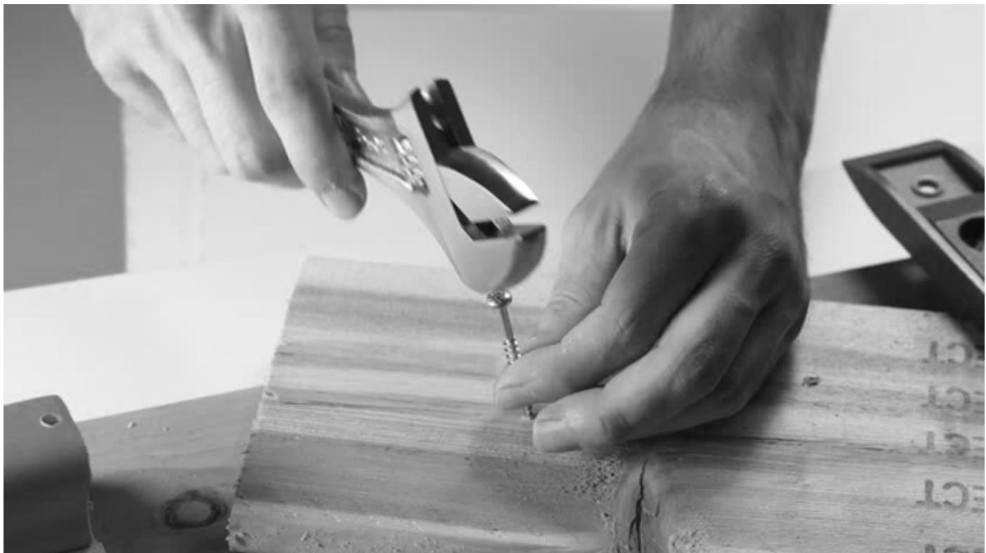
En la imagen, una persona utiliza una llave ajustable para introducir un tornillo en un trozo de madera mientras lo sujetá con los dedos. Esto es altamente inseguro porque la llave no está diseñada para esta tarea, y la mano del trabajador está peligrosamente cerca del punto de contacto. Este método aumenta el riesgo de resbalar y causar lesiones graves en las manos.
